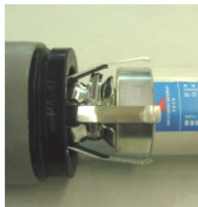
3.Установить в держатель новый предохранитель
