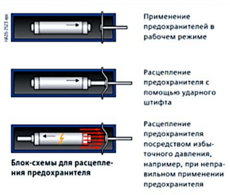
Рисунок 38 - Блок - схемы для расцепления предохранителя
