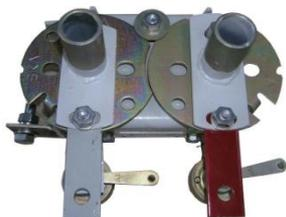
Привод ПРНЗ – это рычажный механизм, предназначенный для ручного включения и отключения разъединителей РЛНД.
